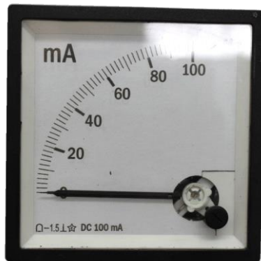
รูปที่ 3.3 มิลลิแอมมิเตอร์ ( Milliammeter ) ย่านวัดขนาด 0-100 mA
