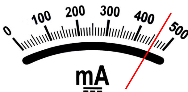
รูปที่ 3.19 ตำแหน่งเข็มชี้ค่ามิลลิแอมมิเตอร์ไฟฟ้ากระแสตรง ใช้ในตัวอย่างที่ 3.1
