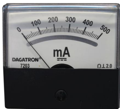
รูปที่ 3.4 มิลลิแอมมิเตอร์ ( Milliammeter ) ย่านวัดขนาด 0-500 mA
