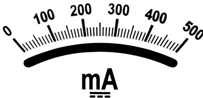
รูปที่ 3.16 สเกลมิลลิแอมมิเตอร์ไฟฟ้ากระแสตรง ย่านวัด 0-500 mA
