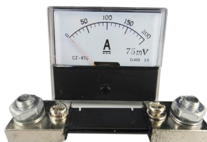
รูปที่ 3.10 แสดงการต่อแอมมิเตอร์ไฟฟ้ากระแสตรงกับตัวต้านทานชนิดภายนอก ขนาด 200 A (ที่มา www.mechashop.weloveshopping.com/store/cartserver/ )
