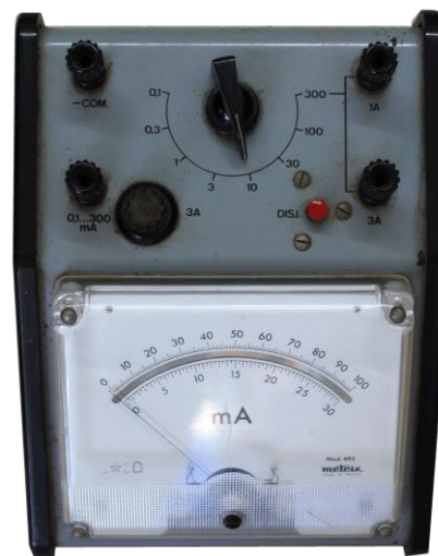
รูปที่ 3.6 แอมมิเตอร์ไฟฟ้ากระแสตรง ย่านวัดขนาด 0-3 A
