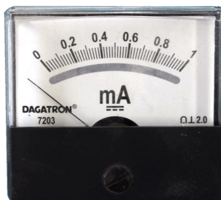
รูปที่ 3.2 มิลลิแอมมิเตอร์ (Milliammeter) ย่านวัดขนาด 0-1 mA
